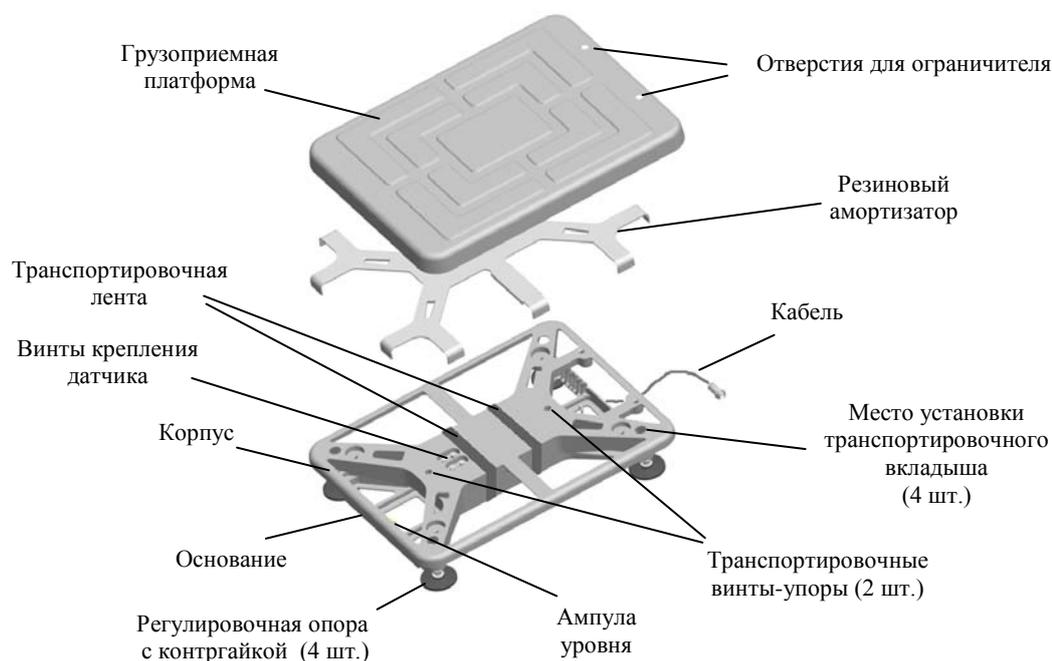
Рис. 4.1 – Модуль взвешивающий ТВ-S\_
